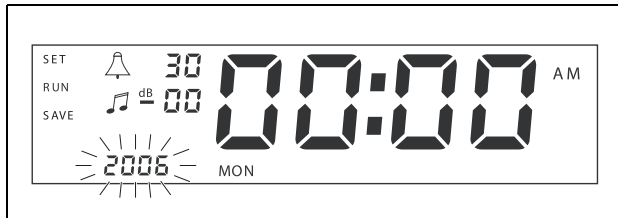
figure 5.1: Début de la séquence de réglage de la date et de l'heure
