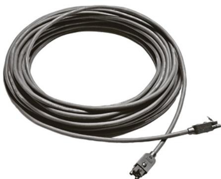
Si tratta di un cavo speciale con due fibre in plastica per comunicazione dati ed audio e dotato di 2 conduttori in rame per l'alimentazione. Il cavo viene fornito con il connettore già inserito. Questo cavo può essere utilizzato per collegare la CCU alle unità di espansione audio.
