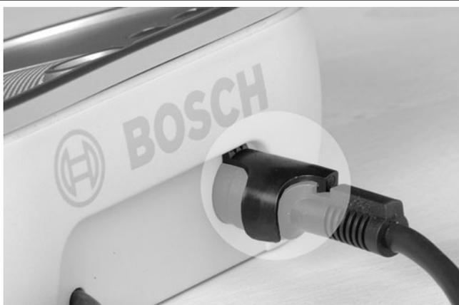
I morsetti per cavo per unità per dibattito DCN-DISCLM consentono di fissare cavi di interconnessione all'unità successiva.
