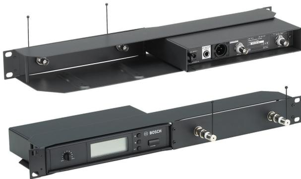
Der Satz ist für die Montage von MW1-RX-Fx Empfängern für Funkmikrofone in 19-Zoll-Gehäuse vorgesehen. Mit ihm können zwei Geräte (jeweils 1 HE) nebeneinander in einem Gehäuse montiert werden. Wenn nur ein Gerät verwendet wird, kann die mitgelieferte Platte, auf der die beiden Antennen installiert werden, in die andere Hälfte des Rahmens eingesetzt werden. Diese Antennen werden über die beiden mitgelieferten BNC-Kabel an den Empfänger angeschlossen.
