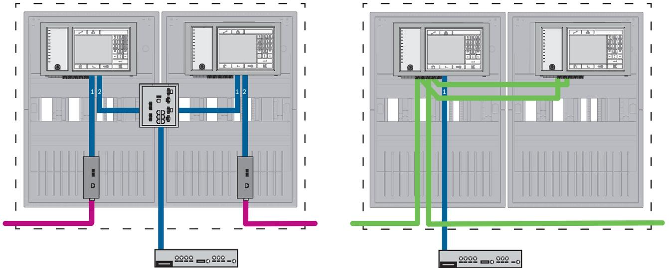
Figura 7.9: Lado esquerdo: na rede Ethernet Lado direito: na rede CAN
