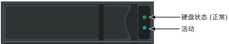
图片 4.13: 硬盘托架LED指示灯
