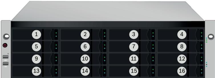
图片 4.6: 3U型号的硬盘插槽编号
