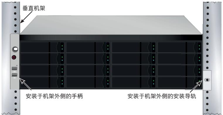
图片 4.5: 已在机架上安装的设备
