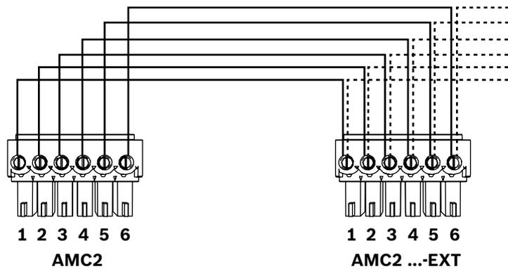
**Abbildung 4.10:** Anschluss eines Erweiterungsmoduls an einen Controller
