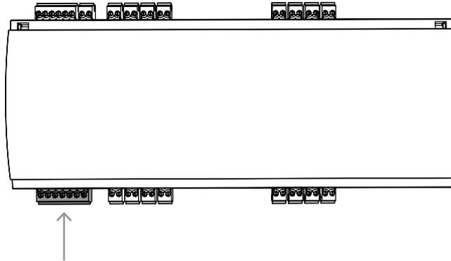
**Abbildung 4.6:** Stromversorgungsanschluss
