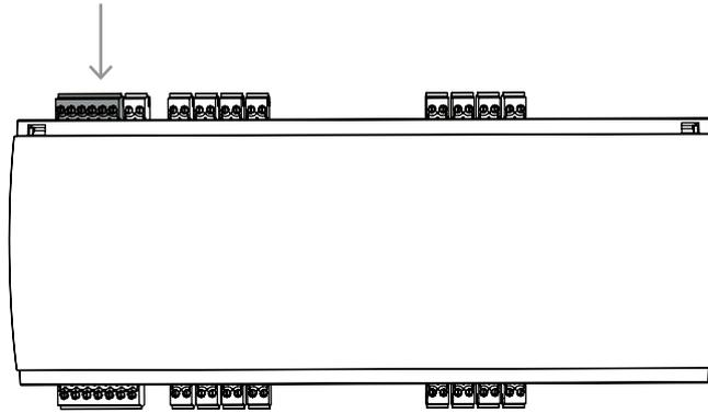
**Abbildung 4.9:** Interner Bus des Stromversorgungsmoduls
