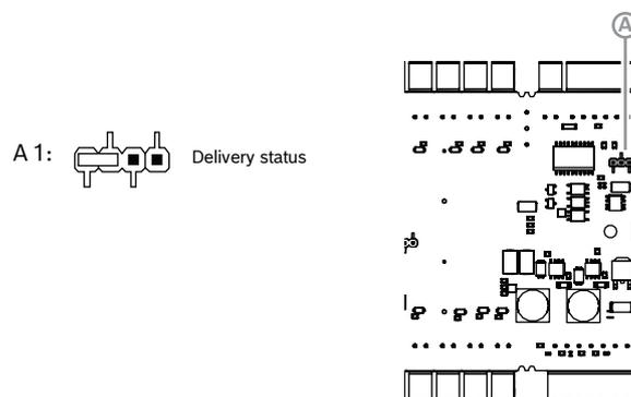
Abbildung 4.5: AMC2-16IE Erdungsjumper an der Unterseite
