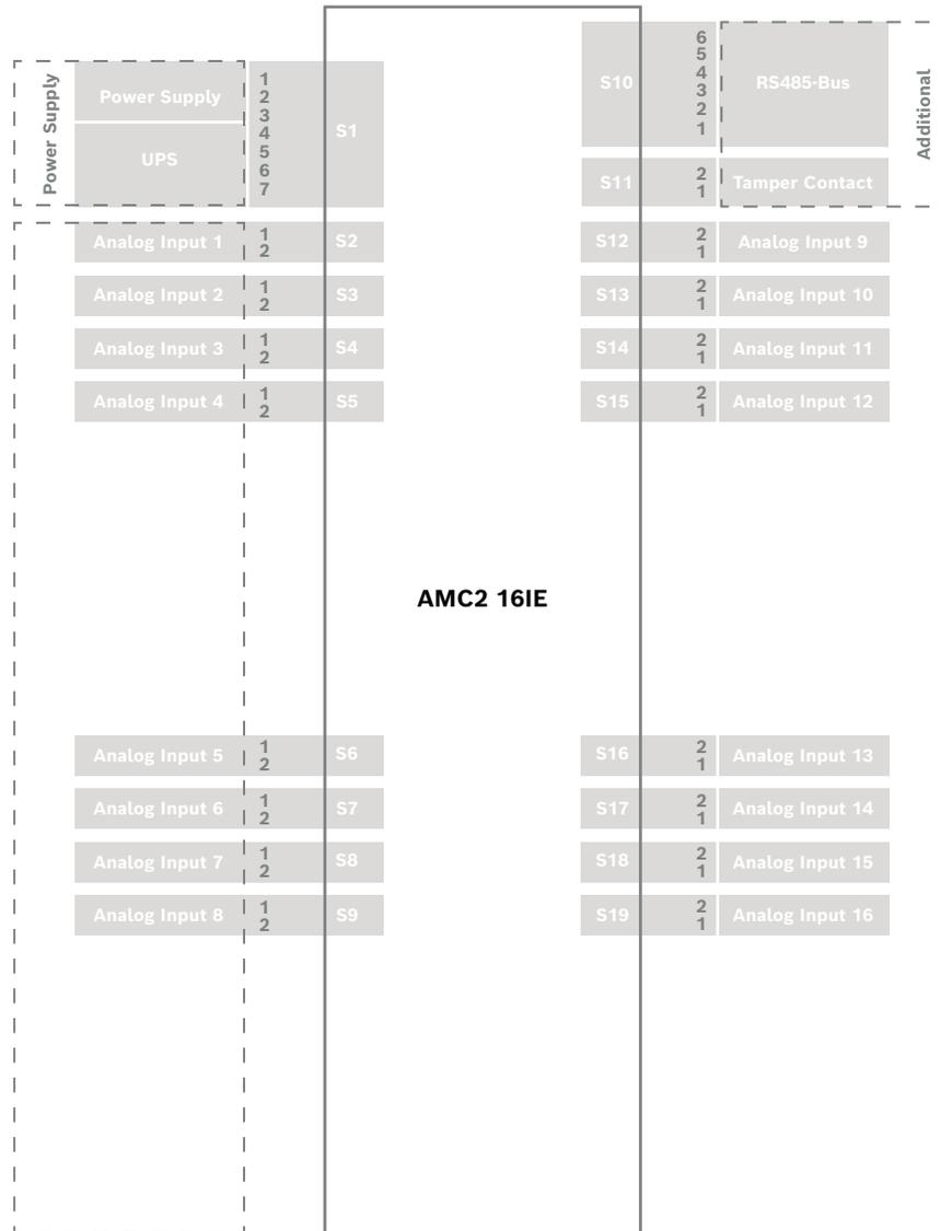
Abbildung 10.1: Anschlussblöcke des AMC2-16IE
