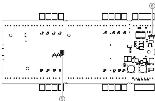
Abbildung 3.3: AMC2-16IE Jumper auf der Unterseite
