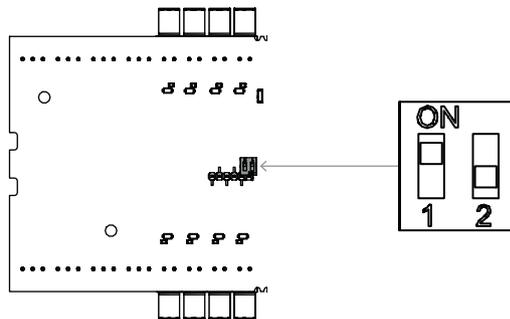
**Abbildung 4.11:** Position des Wahlschalters für Hosteeinstellungen
