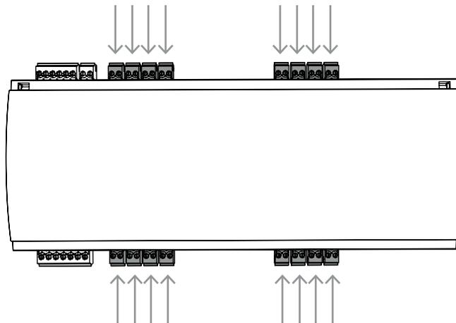
**Abbildung 4.12:** AMC2-16IE Analoge Eingangsanschlüsse
