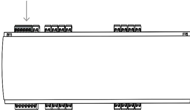
Abbildung 4.7: Schnittstelle für interne Stromversorgung
