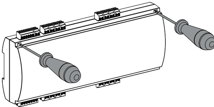
Abbildung 4.3: AMC2-16IE Öffnen des Gehäuses
