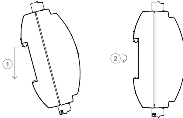
**Abbildung 4.1:** Montage des AMC2-Geräts auf einer Montageschiene
