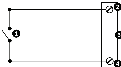
Afbeelding 13.4: N.O. - Normaal open niet-bewaakte aansluitingen
