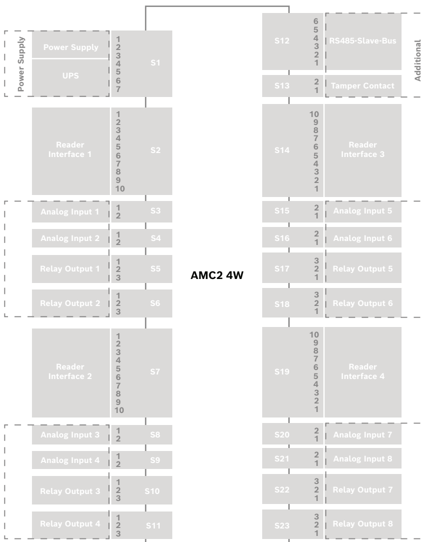
Afbeelding 11.3: Aansluitklemmen van de AMC2-4W
